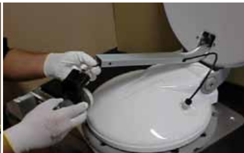
8] Inserire cavo sat all'interno supporto illuminatore
