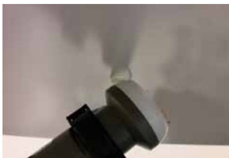
19] Verificare che ad antenna chiusa la parabola sia a contatto con l'illuminatore
