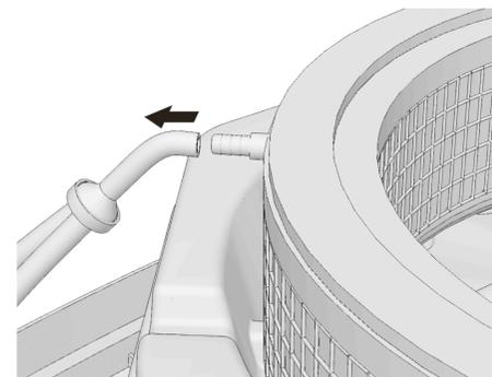
4- Quitar los 2 tornillos que sujetan el tanque/la cuba y desconectar los 2 cables del sensor de nivel, bombas y tubos del agua.
